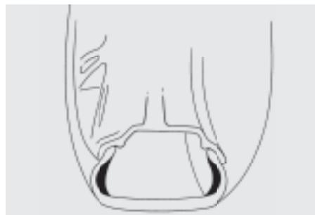
■ **Pneumatici runflat** di serie. Grazie ai fianchi rinforzati, i pneumatici non si appiattiscono mai completamente e rimangono sul cerchione. La spia foratura pneumatici di serie **riduce al minimo i pericoli in caso** di difetto dei pneumatici. Anche una lieve diminuzione della pressione viene segnalata da una spia nel pannello strumenti; se il calo aumenta, scatta un allarme acustico.
