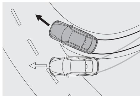
■ **Controllo dinamico della stabilità (DSC),** con CBC e DBC (controllo dinamico dei freni), con funzioni supplementari. Il DSC individua sul nascere l'eventuale tendenza a perdere aderenza e stabilizza l'auto in pochi millesimi di secondo. La sottofunzione della modalità di trazione (DTC) permette un maggiore slittamento delle ruote, per ottimizzare la spinta in base alle condizioni stradali, per una guida più sportiva.
