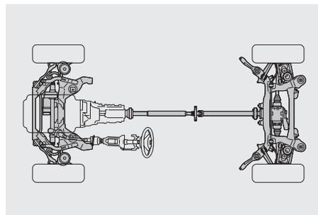
■ **Assetto in struttura leggera** con assale anteriore a doppio snodo e montanti molleggiati e assale posteriore a cinque bracci; per una tenuta di strada impeccabile e una maggior sicurezza di guida, molti componenti dell'assetto sono in alluminio.
