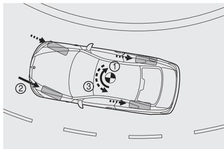
■ **Cornering Brake Control (CBC)** maggiore stabilità di guida in caso di frenate in curva. In frenata, la diminuzione del carico sulle ruote posteriori può portare a un «avvitamento» della vettura (1). Il CBC si oppone a questa tendenza, regolando asimmetricamente la pressione dell'impianto frenante (2) e stabilizzando la vettura (3).
