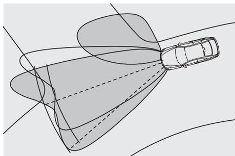
□ **Adaptive Light Control (illuminazione adattativa in curva):** dispone di proiettori mobili che illuminano ogni curva. Speciali sensori rilevano l'angolo di sterzata, il momento di imbardata e la velocità; i proiettori si adeguano automaticamente al tracciato effettivo della curva. Viaggiando di notte o in cattive condizioni di visibilità, l'illuminazione della carreggiata si adegua alla dinamica di guida.
