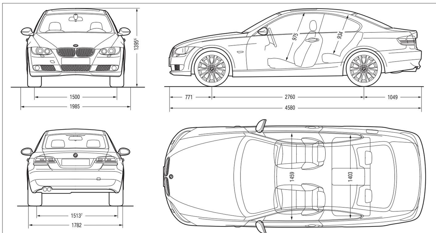
Tutte le misure dei disegni tecnici sono espresse in millimetri. Capacità del vano bagagli 440 litri, 335i e 335d 430 litri (misurazione VDA).
