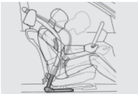
■ **Sistema** di ritenzione BMW per guidatore, passeggero e passeggeri posteriori esterni composto da cintura di sicurezza a 3 punti, pretensionatore e limitatore di ritenzione, per un effetto di ritenzione ottimale in caso di impatto.
