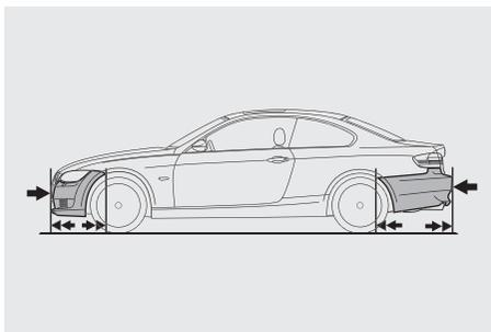
■ **Paraurti** con elementi deformabili in alluminio (posteriori in acciaio) ad assorbimento d'urto senza danni fino a 4 km/h. Speciali zone deformabili anteriori e posteriori assorbono forze d'urto fino a 15 km/h lasciando indenne la carrozzeria.
