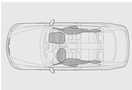
■ **Airbag:** in una BMW gli airbag e tutti gli altri componenti di sicurezza sono armonizzati in modo ottimale. In caso di impatto, ad esempio, si attiva solo l'airbag effettivamente necessario. Sei airbag offrono protezione mirata: airbag anteriori, airbag a tendina per la testa anteriori e posteriori (passanti), airbag laterali anteriori.
